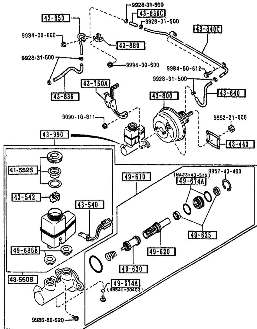
4340 A-1 BRAKE MASTER CYLINDER & POWER BRAKE
