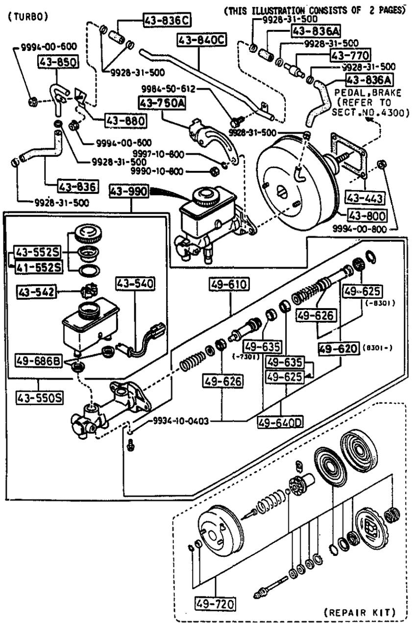
**4340A-2 BRAKE MASTER CYLINDER & POWER BRAKE (ANTI-LOCK BRAKE SYSTEM)**
