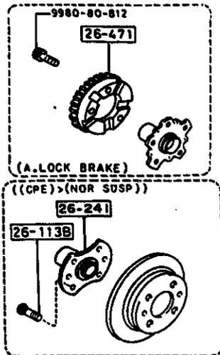
REAR BRAKE MECHANISMS
