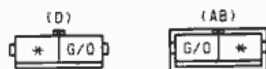
S-07 CONNECTOR BETWEEN DASH (D) & AIR BAG (AB)
